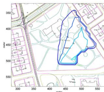
Figur 7.33. Trafikbullersänkning genom att sätta upp en 1,5 m hög bullerskärm mot Engelbrektsgränd.
